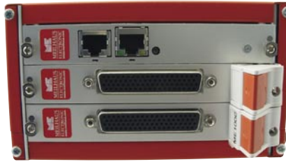
ME-Synapse LAN (ME-1-LAN) mit Ethernet-Modul und zwei aktiven Steckplätzen.
