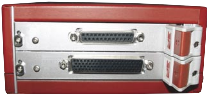
ME-Synapse USB (ME-1-USB) mit einem aktiven und einem passiven Steckplatz.
