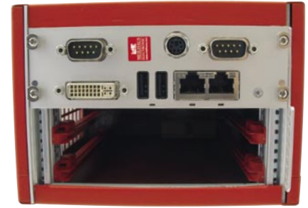
ME-Neuron - vollständige PC-Mess-Station: CPU-Modul und 2 aktive Steckplätze.
