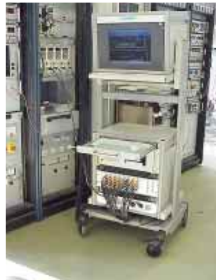
Bild 1: In 19-Zoll-Rack eingebautes Testsystem am Prüfstand.
