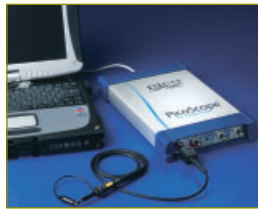
Modulare USB-Oszilloskope am Notebook - stationär auf dem Labortisch oder im mobilen Einsatz.
