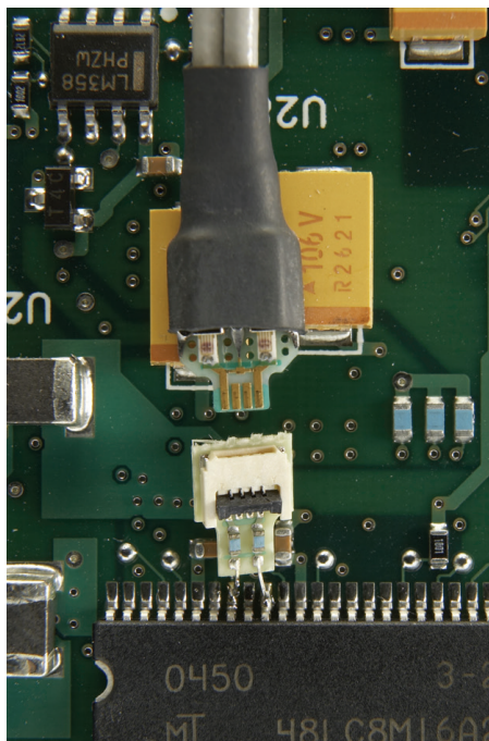
InfiniiMax ZIF tip soldered on board
