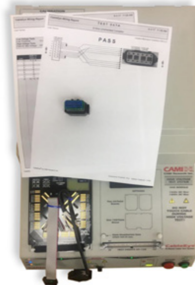
Bild 2: Reverse-Engineering eines Kabels.
