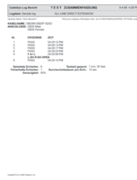
Bild 6: Am Ende des Testvorgangs wird ein Stapelbericht mit den Ergebnissen für jedes Kabel gedruckt.
