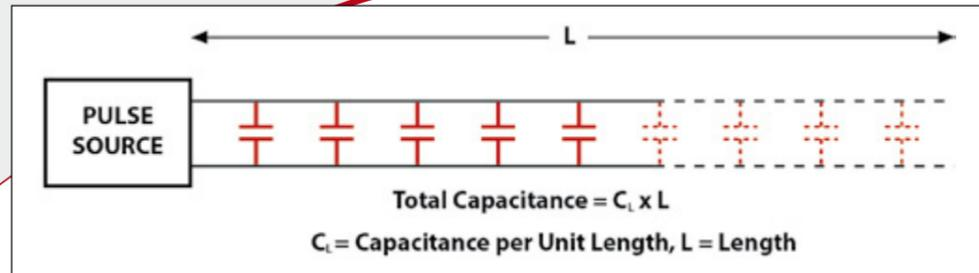
◀ Bild 1: Schematische Darstellung der Kabelkapazität
