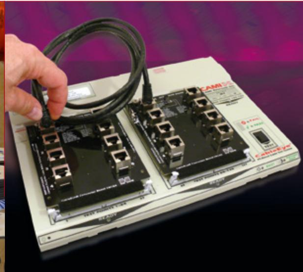
Gleichzeitige Multipoint-Durchgangsprüfung eines mehrere km langen Multicore-Kabels mit CableEye.
