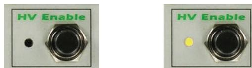
Bild 5: High Voltage Disable/Enable
