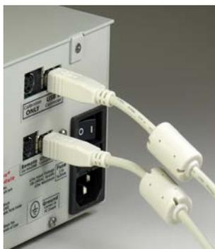
Bild 1: *USB-Kabel mit Ferritkernen*
