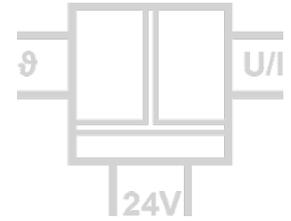
Der programmierbare Temperatur-Messumformer DT 45000 dient zur Erfassung von industriellen Prozesssignalen. Er setzt die Messwerte von Pt, Ni, KTY oder TC Sensoren, sowie Poti, Widerstand und mV-Signale in potentialgetrennte Normsignale um.
