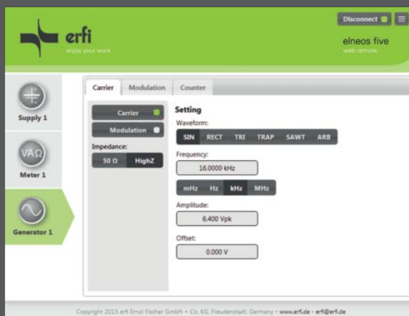
Fernsteuerung Funktionsgenerator und schneller Signalbiträgergenerator: Alle Parameter des Funktions- und Signalbiträgergenerators sind fernsteuerbar.
