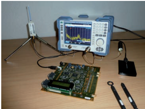
Prinzipieller Messaufbau mit HZ551 und Spektralanalysator
