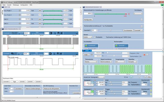
Der Screenshot zeigt die MicroLC Software mit analogen Ausgängen, Kurbel- und Nockenwellen, RPM und komplexer PWM.
