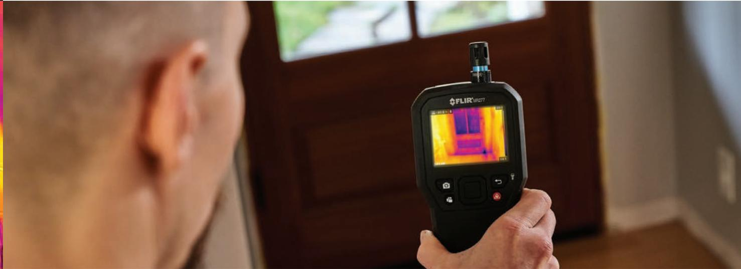
Das MR277 Gebäudeinspektionssystem vereint die Vorteile eines hochauflösenden Infrarot-Bildgebungssensors mit der FLIR MSX® Bildoptimierungstechnologie und einem Laserpointer. Damit können Sie kritische Feuchtigkeits- und Gebäudehüllenschäden rasch lokalisieren, deutlich erkennen und einfach dokumentieren.
