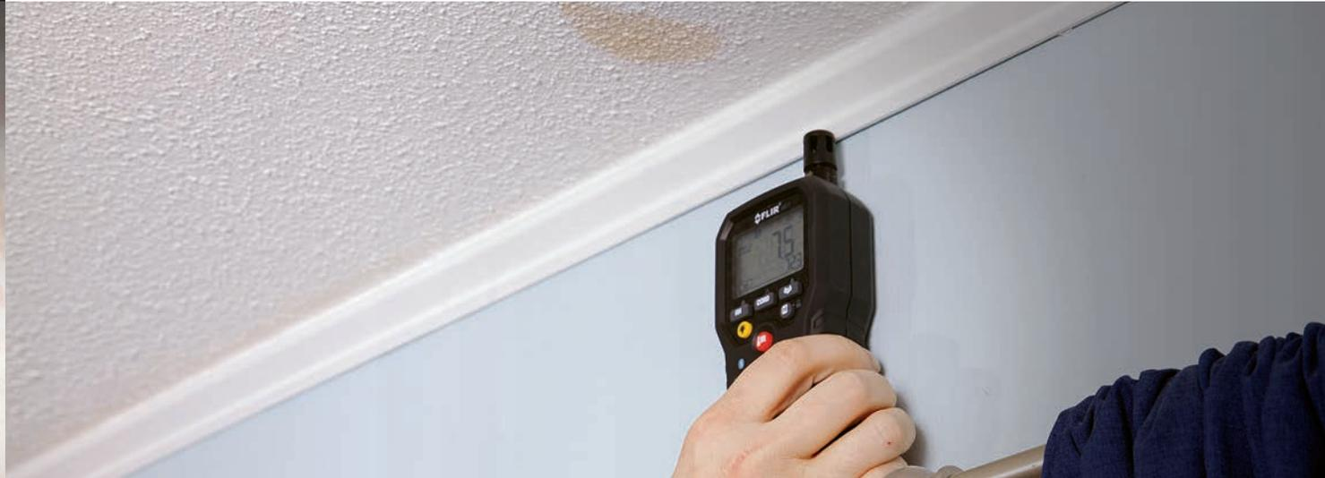
Das MR77 vereint alle Sensoren und Funktionen, die Sie zur Feuchtigkeitssanierung oder Überprüfung von HLK-Systemen benötigen, in einem Messgerät: eine Bluetooth® METERLiNK-Funktion, einen stiftlosen Feuchtigkeitssensor und einen Stiftsensor, einen Temperatur- und relativen Luftfeuchtesensor und ein IR-Pyrometer.
