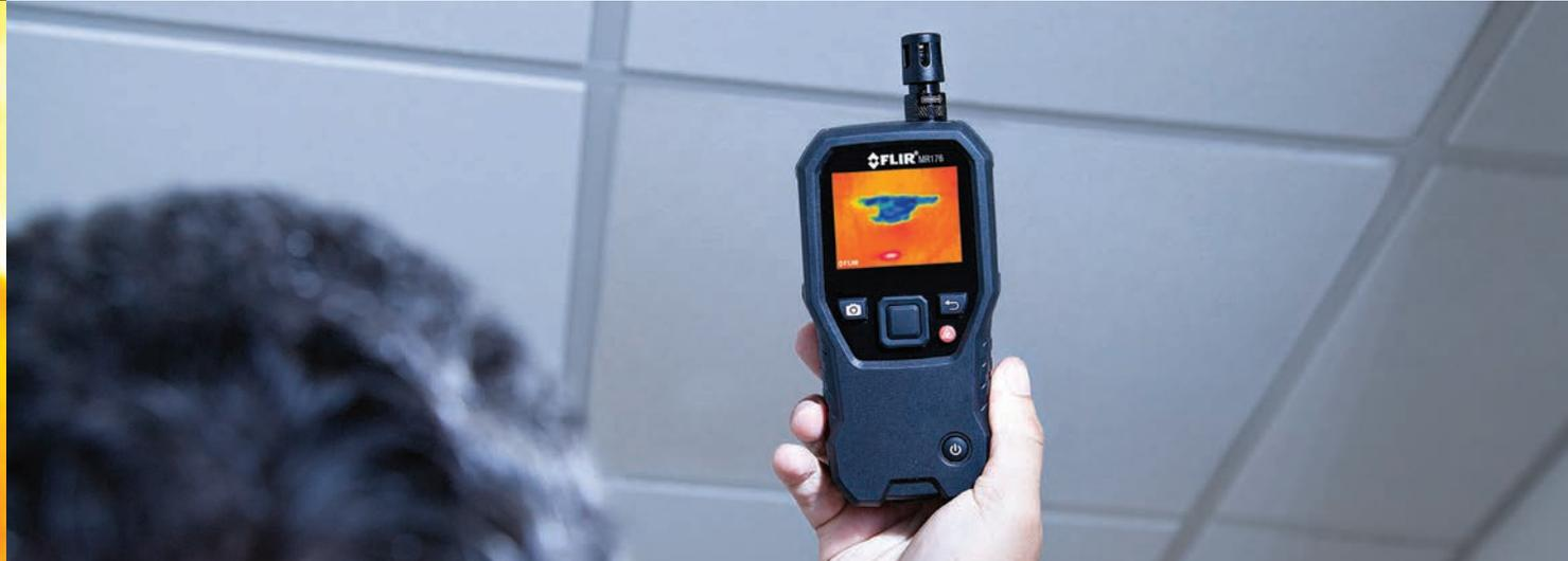
Das MR176 und das MR160 können Sie mit ihrer infrarotgesteuerten Messhilfetechnologie IGM und ihrem integrierten Wärmebildsensor visuell genau zu dem Punkt mit potenziell verborgener Feuchtigkeit führen, der näher überprüft und begutachtet werden sollte.
