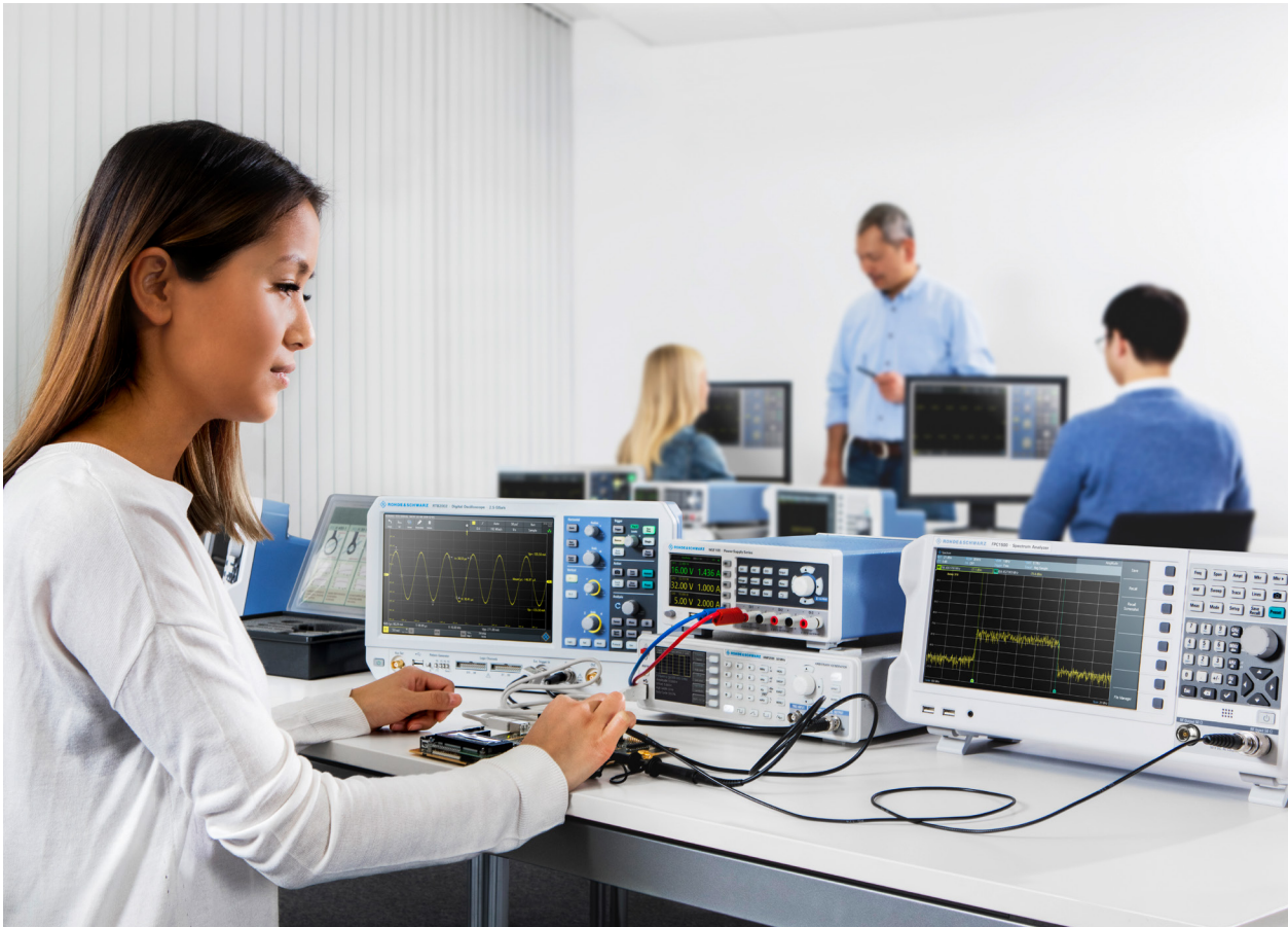
Typischer Messaufbau in einem Universitätslabor mit dem R&S®FPC1500, einem Oszilloskop und einem Netzteil
