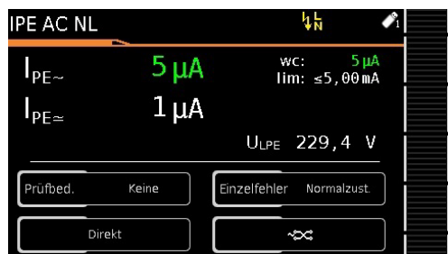
Prüfsequenz – IPE-Messung (IEC 62368 / EN 62368 / VDE 0868-1)
