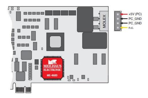
Abbildung 1: Zusatzversorung PCI-Express-Modelle
