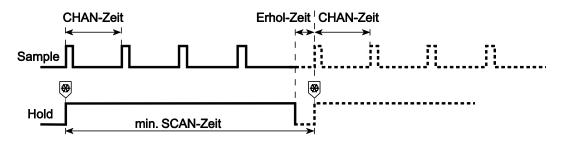
Abbildung 9: Sample & Hold-Timing
