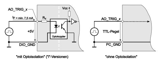
Abbildung 17: Beschaltung der D/A Triggereingänge
