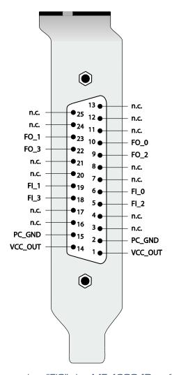
Abbildung 32: Zusatzstecker "FIO" der ME-4600 [Draufsicht]
