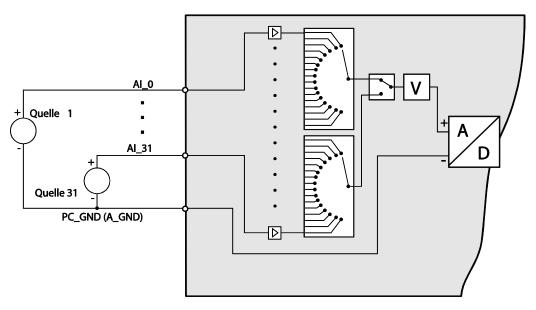
Abbildung 6: Beschaltung im Single-ended-Betrieb
