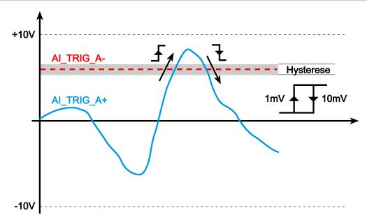
Abbildung 11: Analog-Trigger
