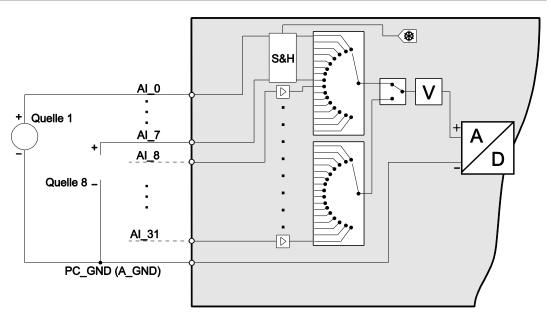
Abbildung 8: Beschaltung im Simultan-Betrieb
