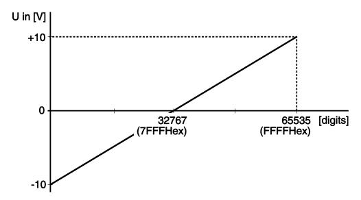
Abbildung 14: Kennlinie der DIA Kanäle
