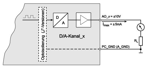
Abbildung 15: Beschaltung der analogen Ausgänge
