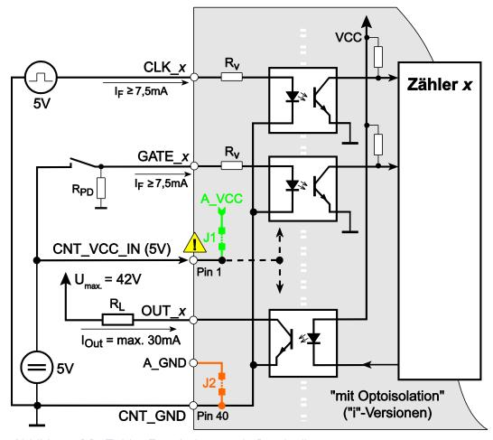
Abbildung 23: Zähler-Beschaltung mit Optoisolierung
