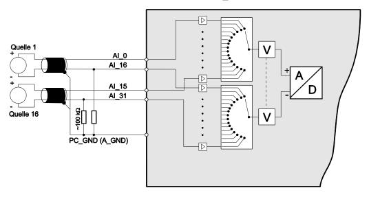
Abbildung 7: Beschaltung im differentiellen Betrieb
