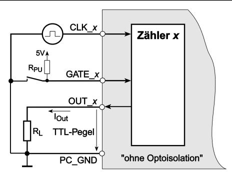
Abbildung 21: Zähler-Beschaltung ohne Optoisolierung
