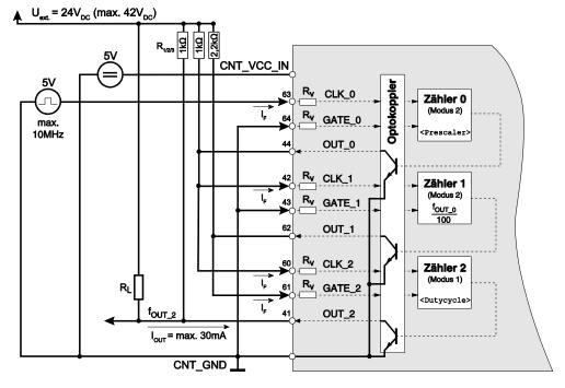
Abbildung 25: PWM-Beschaltung mit Optoisolierung
