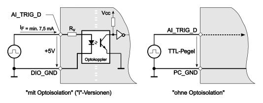
Abbildung 13: Beschaltung Digital Trigger
