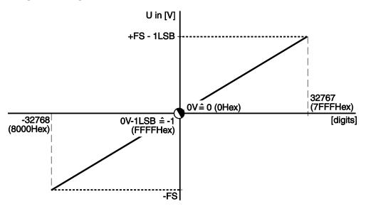
Abbildung 4: Kennlinie für bipolare Eingangsbereiche
