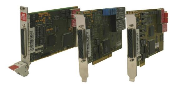
16-bit Multi-I/O-Karte mit bis zu 32 A/Dund 4 D/A-Kanälen.
