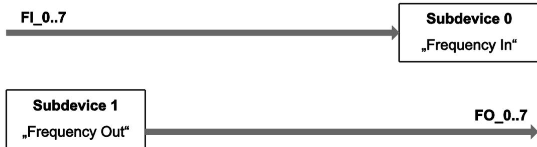
Abbildung 10: Frequenz-Ein-/Ausgabe im Single-Betrieb
