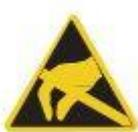
Die Handhabung der Karte sollte mit Umsicht erfolgen, um sicherzustellen, dass das Gerät nicht durch elektrostatische Entladung (ESD), mechanische Beanspruchung oder unerlaubte Stromstöße beschädigt wird. Außerdem sind Vorsichtsmaßnahmen zu ergreifen, um einen Stromschlag zu vermeiden. Gewährleisten Sie, dass Standard-ESD-Schutzmaßnahmen befolgt werden. Dazu sollte mindestens eine Hand geerdet sein, um statische Aufladung abzuleiten:
