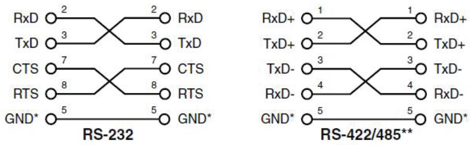
Abbildung 68: Nullmodemkabel ME-9000/9100/9300
