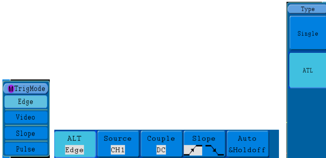
Abb.33 Menü für alternierenden Trigger (ALT) (Triggertyp: Edge)
