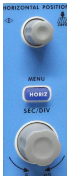
Abb. 11 Bedienelemente für Horizontalsteuerung
