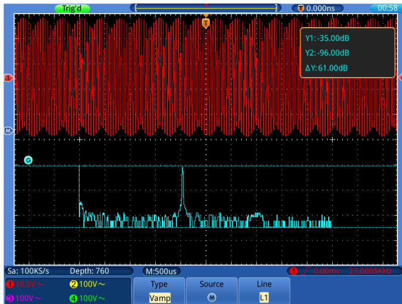
Bild 0-9 Amplituden Cursor-Messung für FFT
