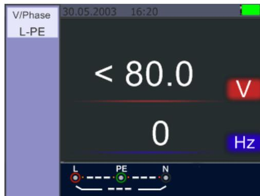
Standby Anzeige der Spannungsmessung (< 80V)
