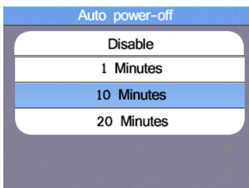
Um die Einsatzdauer der geladenen Akkus zu verlängern, sollte sich das Gerät nach einigen Minuten automatisch deaktivieren (Auto Power Off). Hierdurch wird ein vollständige Entladen des Akkus verhindert, sollte das Gerät versehentlich nicht manuell abgeschaltet worden sein.
