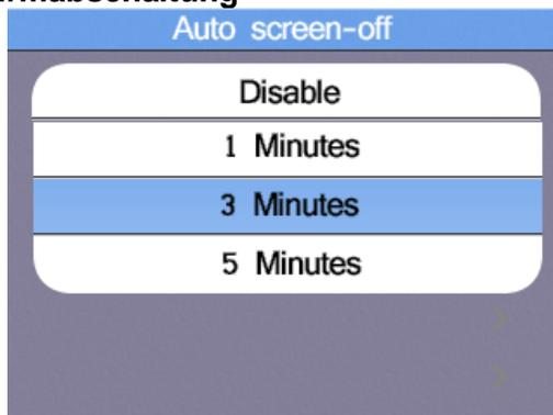
Um die Einsatzdauer der geladenen Akkus zu verlängern, sollte sich der Bildschirm nach einigen Minuten automatisch deaktivieren (Auto Screen Off), da die Hintergrundbeleuchtung der größte Einzelverbraucher im Gerät ist.
