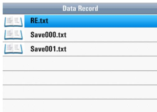
Im Menü Data Record sehen Sie eine Übersicht der zuvor abgespeicherten Messwerte als Textdatei für Einzelwerte oder Datalogger-Dateien. Drücken Sie die ▲ oder ▼ Tasten um durch das Menü zu navigieren und bestätigen Sie die Auswahl mit der □ -Taste (Enter). Folgende Ansicht erscheint nach Auswahl einer gespeicherten Datei:
