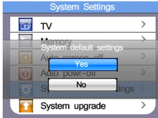
Sollte das Gerät Probleme bei der Anwendung zeigen oder versehentlich Einstellungen verändert worden sein, kann eine Rücksetzung auf Werkseinstellungen (System Default) helfen. Drücken Sie die ▲ oder ▼ Tasten um zwischen YES (JA) oder NO (NEIN) umzuschalten und bestätigen Sie die Auswahl mit der □ -Taste (Enter).
