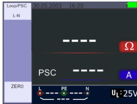
1. Drehen Sie den Drehschalter in die LOOP/PSC - Position.
