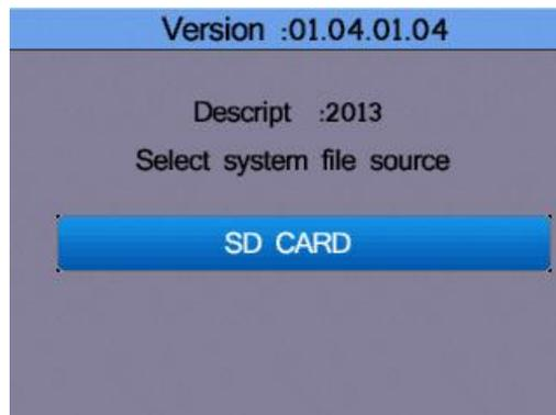
Sollte ein Firmware Update zur Verfügung stehen, kann dieses auf eine SD-Karte gespeichert werden und als Quelle für ein Update zur Verfügung stehen. Firmware Updates sollten nur von Fachpersonal ausgeführt werden, da eine falsche Anwendung das Gerät beschädigen kann.
