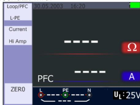
1. Drehen Sie den Drehschalter in die LOOP / PFC Position.
