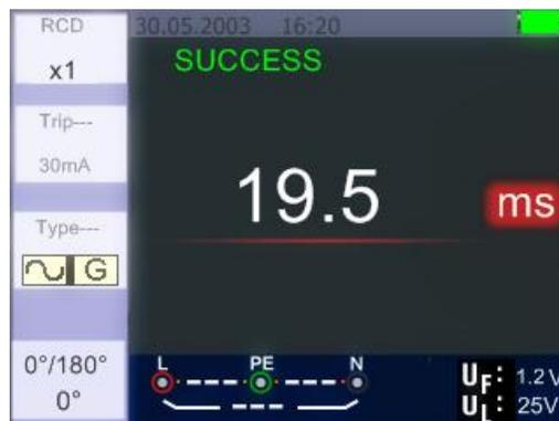
1. Drehen Sie den Drehschalter in die Position RCD
