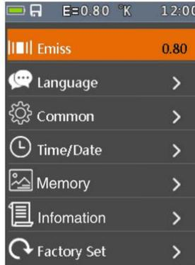
Drücken Sie die Tasten mit den Pfeilen nach oben und nach unten, um durch die Menüpunkte zu gehen. Taste mit dem Pfeil nach rechts oder Menütaste wählen den Punkt aus bzw. gehen in die nächste Menüebene. Taste mit dem Pfeil nach links schließt das Menü bzw. macht die Auswahl rückgängig. Die Tasten MODE/RANGE/HOLD/IR schließen das Menü aus jedem Unterpunkt heraus.
