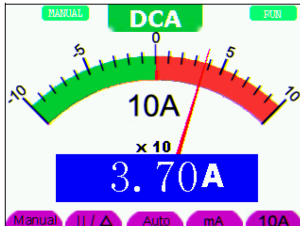
Abbildung 24: Gleichstrommessung <10 A (DCA)
