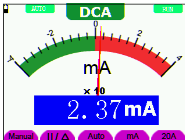
Abbildung 23: Gleichstrommessung <400 mA (DCA)
