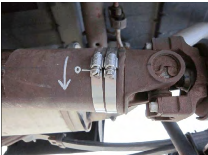
Bild 1b: Mit den Schellen definiert man schnell und eindeutig die Position des Anfangswertes und über Reflektion kann hier der optische Sensor Unwucht erkennen und in der Software mit dem Abstand zum Startpunkt in Millimeter ausgeben.
