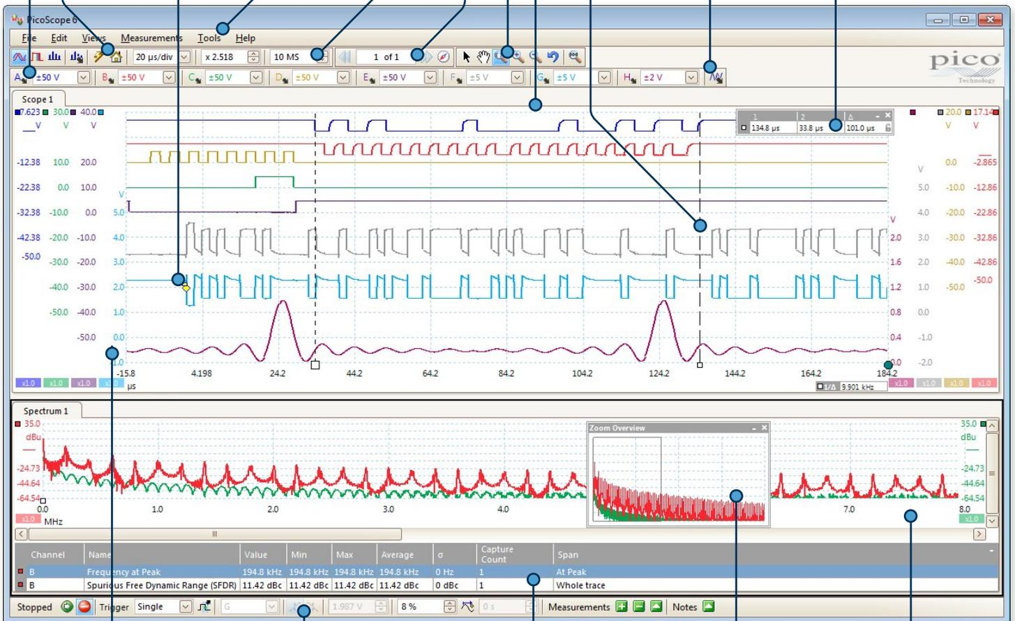
**Verschiebbare Achsen:** Die vertikalen Achsen können nach oben und nach unten gezogen werden. Diese Funktion ist besonders nützlich, wenn eine Wellenform eine andere verdeckt. Zusätzlich ist ein Befehl zum automatischen **Anordnen von Achsen** verfügbar.
