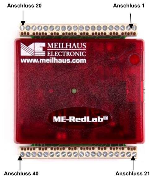
Abb. 3-2. Anschlussbelegung des RedLab 1024HLS
