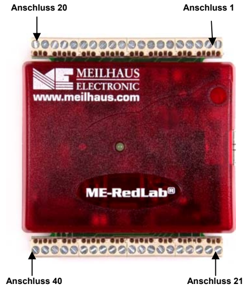
Abb 3-2. Die Anschlussnummerierung des RedLab 1208LS
