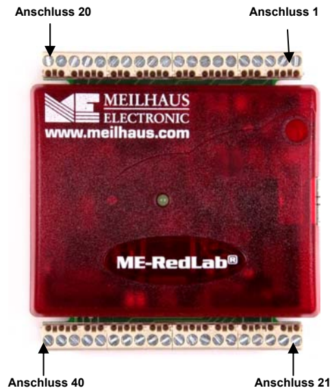
Abb. 3-2. Anschlussbelegung des RedLab 1208FS
