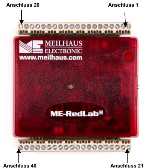
Abb. 3-2. Anschlussbelegung des RedLab 1408FS
