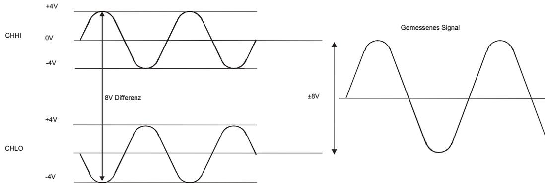
Abb. 3-5. Beispiel für eine Differenzialspannung: Gleichtaktspannung von 0 V
