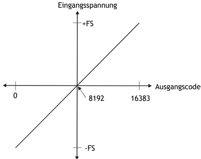
Abb. 3 10. Ideale ADC-Übertragungsfunktion
