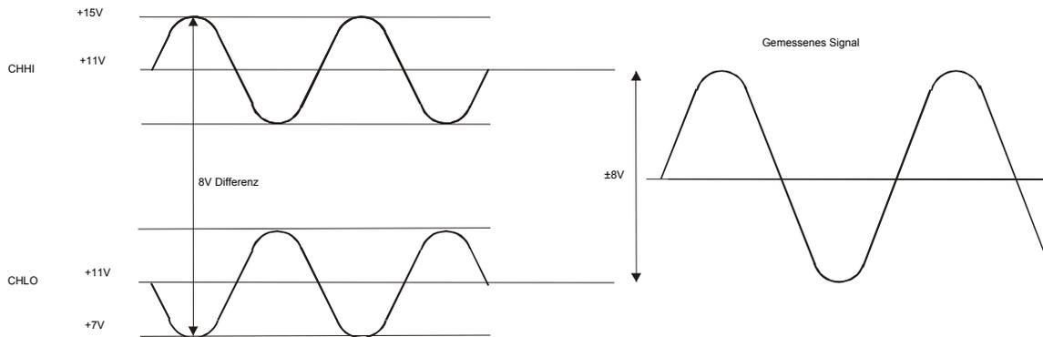
Abb. 3-6. Beispiel für eine Differenzialspannung: Gleichtaktspannung von 11 V
