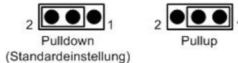
Abb. 9. Konfigurationen der Steckbrücke W1
