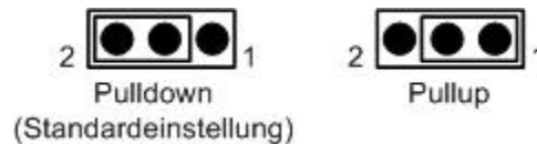
Abb. 9. Konfigurationen der Steckbrücke W1
