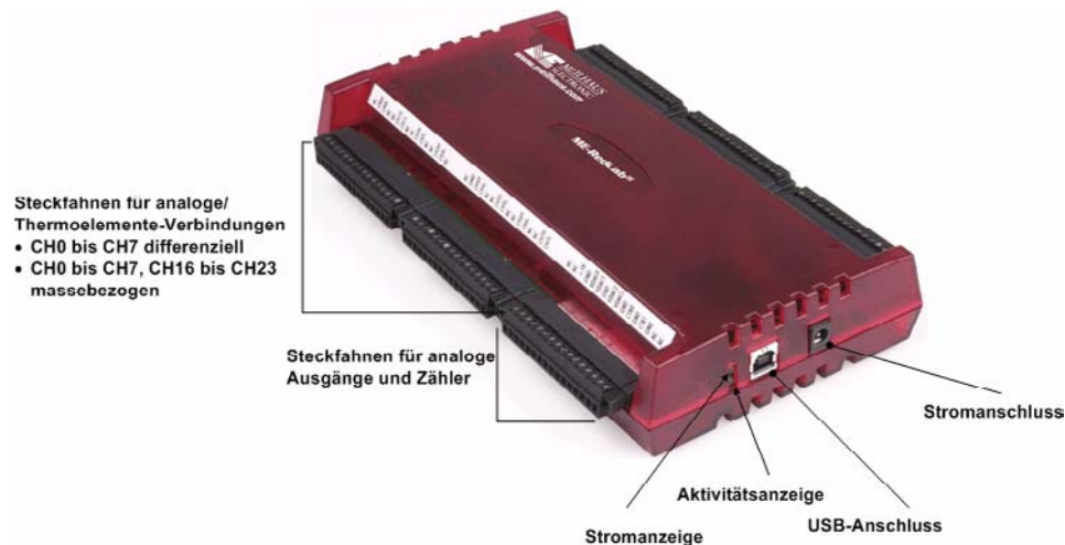
Abb. 6. Komponenten des RedLab 2416-4AO (von vorn gesehen)
