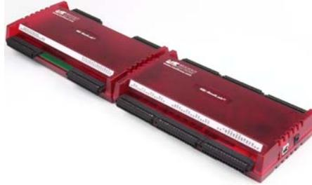
Abb. 1. Direkte Verbindung des RedLab AI-EXP32 mit einem RedLab 2416-4AO
