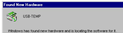
Wenn dieses Fenster bzw. Dialogfeld verschwindet, ist die Installation abgeschlossen. Die **USB-LED** blinkt auf und leuchtet dann kontinuierlich. Dadurch wird angezeigt, dass zwischen dem RedLab TEMP und Ihrem Computer eine Verbindung besteht.
