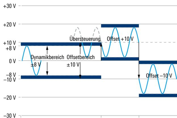
max.  $\pm 30$  V zerstörungsfreie Eingangsspannung
