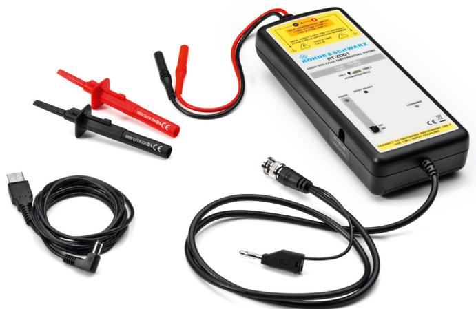
Der R&S®RT-ZD01 differenzielle Hochspannungstastkopf bietet eine Bandbreite von 100 MHz für Eingangsspannungen bis 1400 V. Die BNC-Schnittstelle macht diesen Tastkopf zum idealen Begleiter des R&S®RTB2000.
