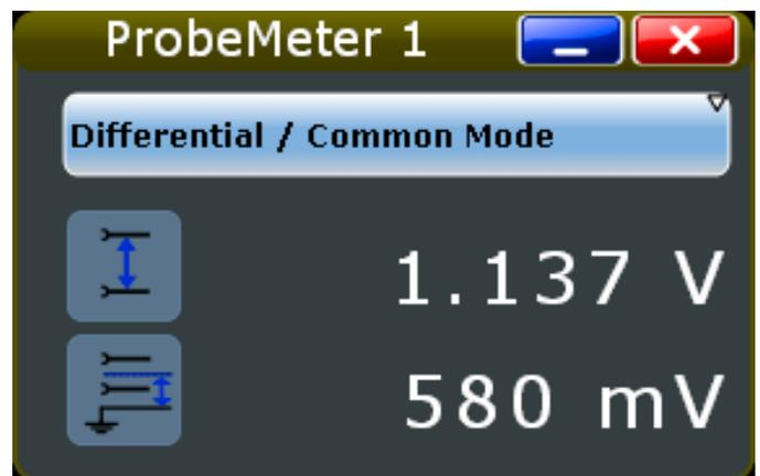
R&S®ProbeMeter: hohe DC-Messgenauigkeit, unabhängig von der Geräteeinstellung und parallel zum Messkanal
