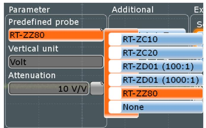
Auswahl vordefinierter Tastköpfe mit SMA- oder BNC-Anschluss am R&S®RTO
