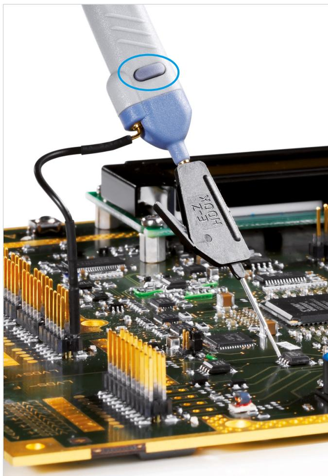
Praxisgerecht ausgelegt: Mikrotaster zum komfortablen Steuern des Geräts
