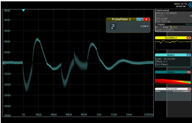
Genauer Nachweis von DC-Pegel und Lastverhalten der Spannungsversorgung während der Initialisierung eines DDR3-Speichers mit dem R&S®ProbeMeter und den flexiblen Mathematikfunktionen des R&S®RTO.
