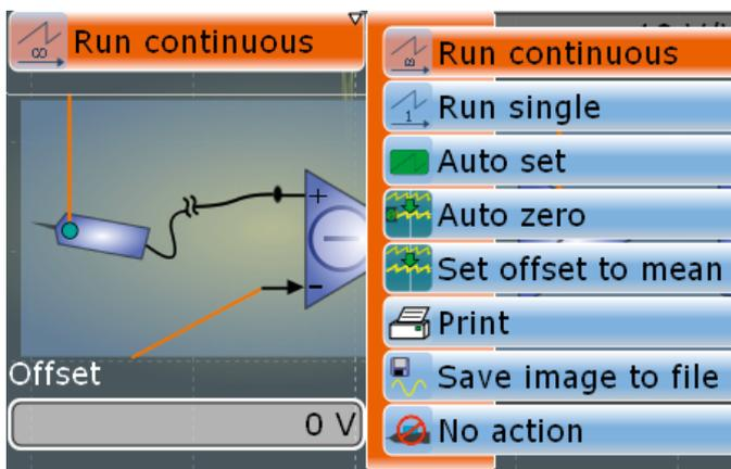
Flexible Konfigurierbarkeit der Mikrotaster-Funktion am Oszilloskop
