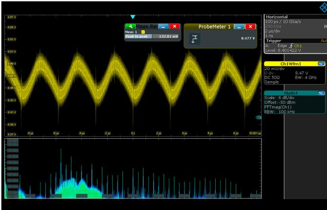
Dank der hohen Bandbreite der R&S®RT-ZPR Power-Rail-Tastköpfe lassen sich selbst hochfrequente Störanteile erfassen, die mit der Spektrumanalysefunktion des R&S®RTO problemlos analysiert werden können.
