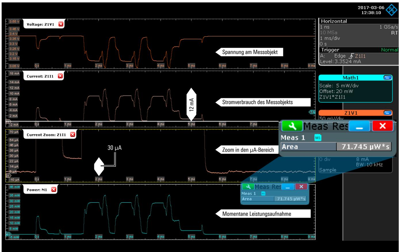
Dank der hohen Dynamik der R&S®RT-ZVC Tastköpfe ist die Stromaufnahme eines Moduls im aktiven und im Ruhemodus messbar, in diesem Beispiel 12 mA und 30  $\mu\text{A}$ . Automatisierte Messungen ermöglichen die Berechnung des Gesamtenergieverbrauchs.
