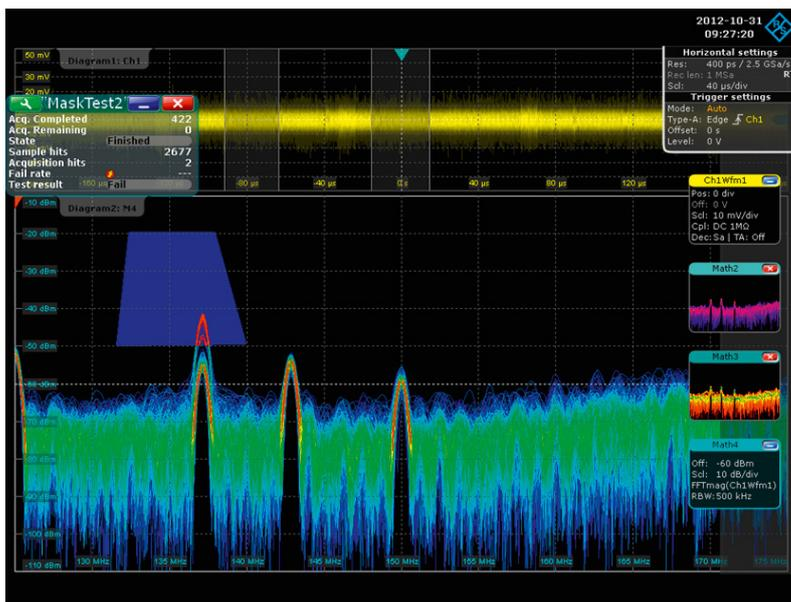
Direkte Erfassung und Analyse sporadisch auftretender EMV-Abstrahlungen dank der leistungsfähigen Spektralanalyse der R&S®RTO Oszilloskope
