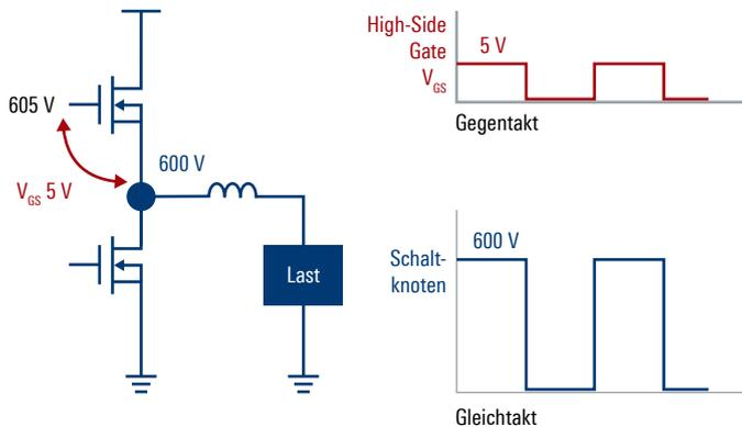
In isolierten Leistungswandlern bleibt das Messobjekt durch das Fehlen einer gemeinsamen Masse potenzialfrei. In einem Messaufbau mit einem Massebezug entstehen Masseschleifen, durch die Gleichtaktstörungen einkopeln können und sensible Messergebnisse verfälschen. Dies kommt häufig bei dreiphasigen Umrichtern und Motorantrieben mit hoher Leistung vor.
