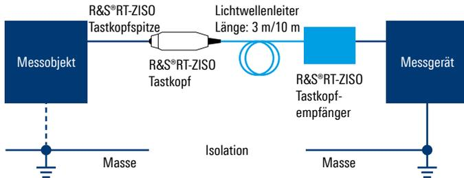
Die Signalübertragung vom Tastkopf zur Tastkopfempfängerbox erfolgt über eine optische Verbindung; die nötige Stromversorgung für den Tastkopf erfolgt über Glasfaser. Der Tastkopf benötigt keine externe Stromquelle, was das Risiko einer Gleichtaktschleife beseitigt. Alternativ kann eine Batterie als Stromquelle verwendet werden.
