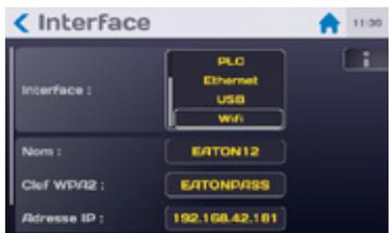
Konfiguration der Kommunikationsparameter
