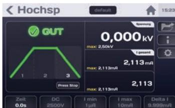
Funktion zur Prüfung der Durchschlagsfestigkeit
