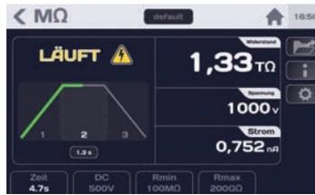
Funktion zur Prüfung der Isolation
