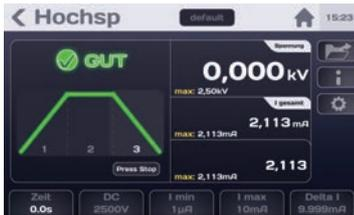
Funktion zur Prüfung der Durchschlagsfestigkeit
