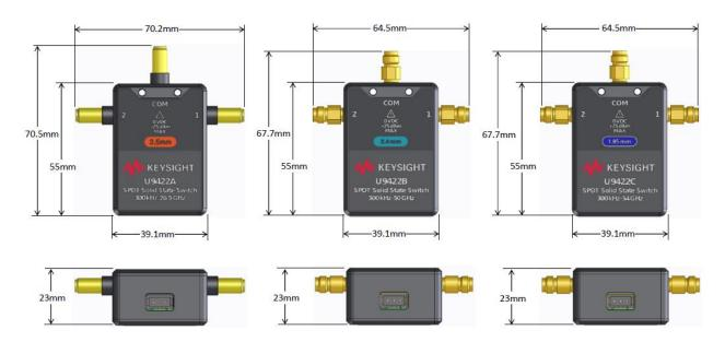
Figure 9. U9422x dimension (option 001), SPDT
