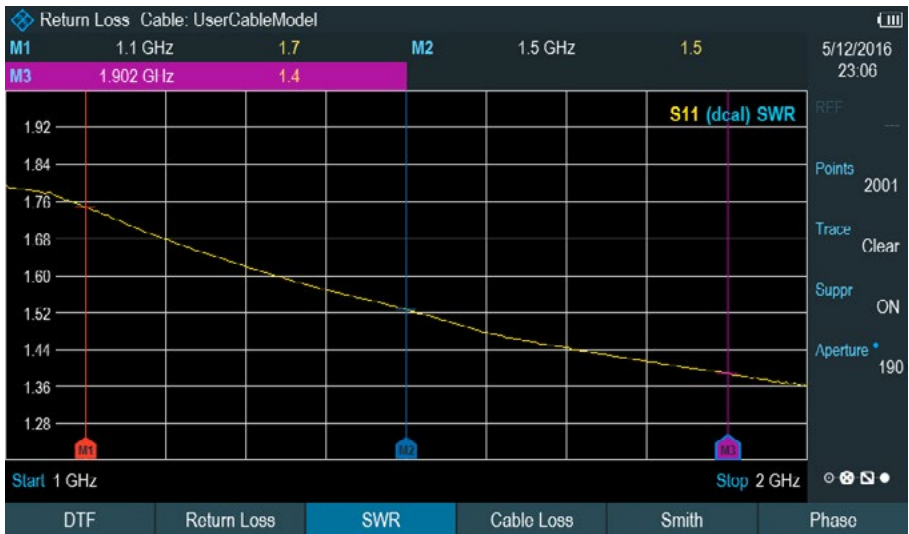
Messung des Stehwellenverhältnisses (VSWR)
