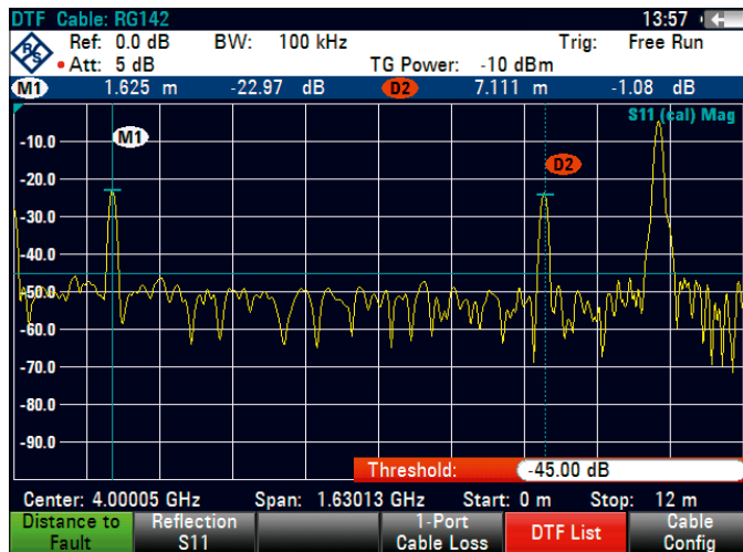
Kabelfehlstellenmessung (Distance-to-Fault, DTF)
