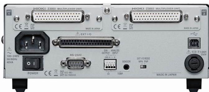
Abbildung 2: Rückseite des RM3545-02 (mit zwei Multiplexer-Karten Z3003)
