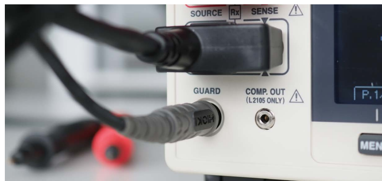
Abbildung 4: Guard-Anschluss: Stabilere Messungen in hohen Widerstandsbereichen
