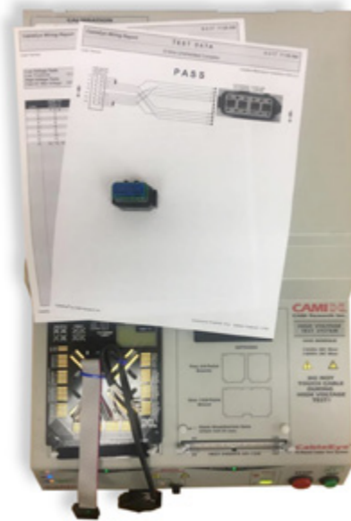
Bild 2: Reverse-Engineering eines Kabels.
