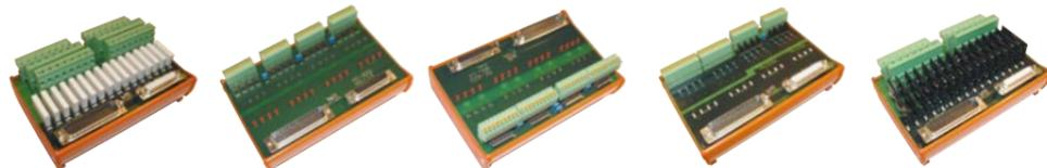
3x, 6x oder 15x 16-bit-Zähler und 24 oder 48 TTL-Digital-I/O-Kanäle für PCI-Express, DIO erweiterbar mit externen Optokopplern, EM- oder SSR-Relais (elektromechanisch/Halbleiter), Pullup/-down.
