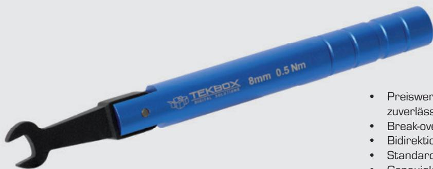
Der TekBox TBTWR-05NM SMA-Drehmomentschlüssel ist ein Break-Over-Typ mit einer Standard-SMA-Öffnung von 5/16" (8 mm) und eignet sich auch für 3,5-mm- und 2,92-mm-Stecker.
