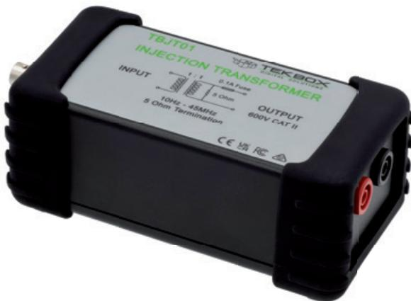
Die TekBox TBJT01 und TBJT02 sind Breitband-Injektionsübertrager für Stabilitätsmessungen im Regelkreis. Sie bieten eine galvanische Trennung zwischen der Sweep-Signalquelle und der Regelschleife. Die Injektionsübertrager sind intern mit einem 5- $\Omega$ -Widerstand abgeschlossen und mit einer 100-mA-Sicherung geschützt. Der nutzbare Frequenzbereich ist 10 Hz bis 45 MHz (TBJT01) oder 1 Hz bis 7 MHz (TBJT02).
